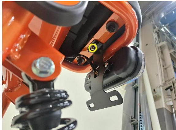
Irrota istuimen kiinnitysmutteri (kiintoavain 10 mm).
